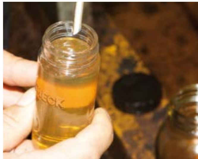
» Eine Ölanalyse gibt aber nicht nur Auskunft über das Öl selbst. Die Prüfdaten sagen auch einiges über den Maschinenzustand aus. » An oil analysis provides information not just about the oil – the test data also reveals a lot about the condition of the machine itself.
