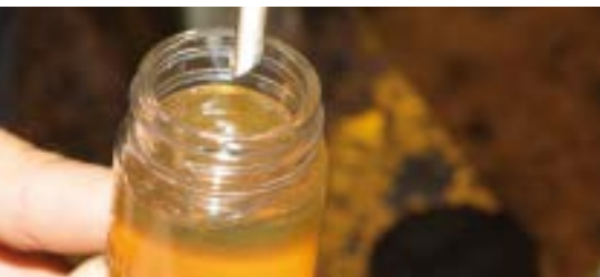
Korrekte Ölprobeentnahme Correct oil sampling
