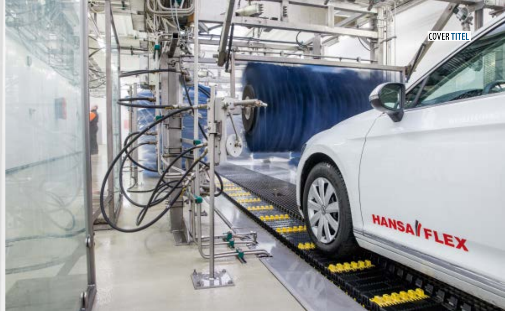
» Zunächst vermisst ein Scanner das komplette Fahrzeug. Alles wird erfasst und an die zentrale Steuerung der Anlage weitergegeben. Sie koordiniert die Walzen, Düsen, Rotoren und Pendel. » First a scanner surveys the complete vehicle. Everything is recorded and passed to the car wash's central control, which coordinates the eventual ballet of rollers, jets, rotors and pendulums.
