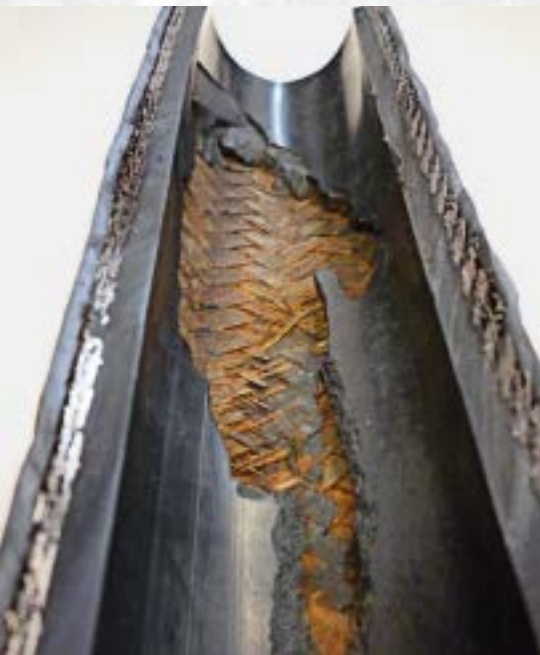
» Eine durch Auswaschung zerstörte Schlauchinnenschicht. » A hose inner layer severely damaged by erosion.
