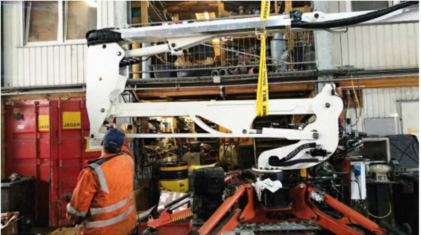
» Die Revision des Hubsteigers war dann Routine: In weniger als zwei Tagen tauschte Kraxner rund 200 m Schlauchleitungen aus, die an Bord des Servicefahrzeugs abgelängt und verpresst wurden.
