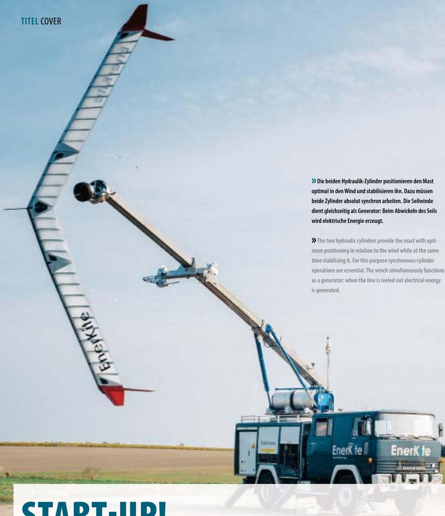
» Die beiden Hydraulik-Zylinder positionieren den Mast optimal in den Wind und stabilisieren ihn. Dazu müssen beide Zylinder absolut synchron arbeiten. Die Seilwinde dient gleichzeitig als Generator: Beim Abwickeln des Seils wird elektrische Energie erzeugt.
