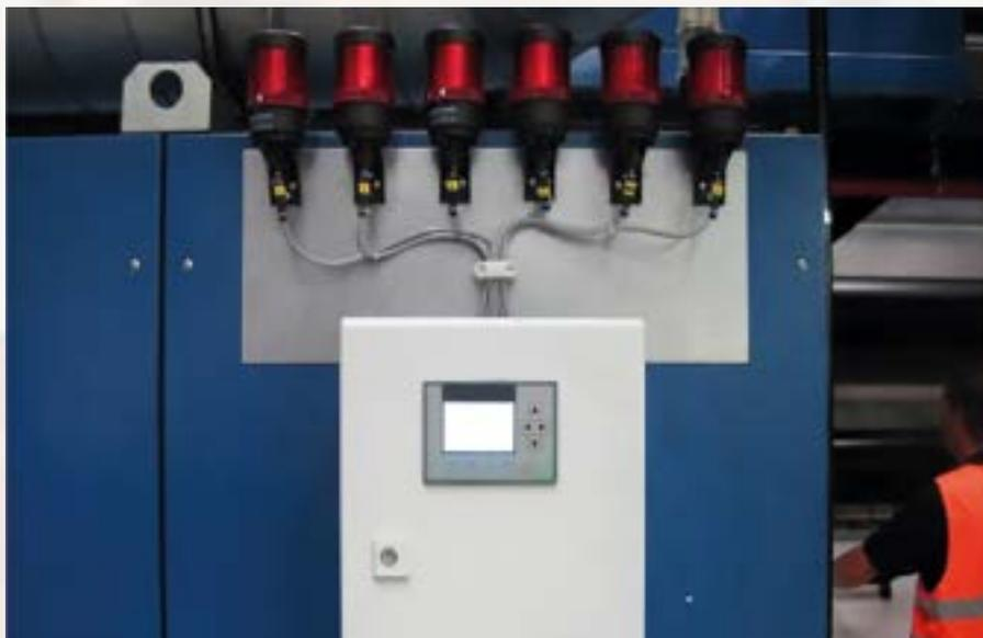
» Steuerung von Wassersensoren an einer Kunststoffspritzgussmaschine.
