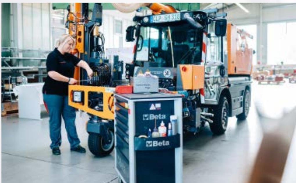
» Beim Sinkkastenreiniger sind viele unterschiedliche Hydraulikkomponenten auf engstem Raum verbaut.
