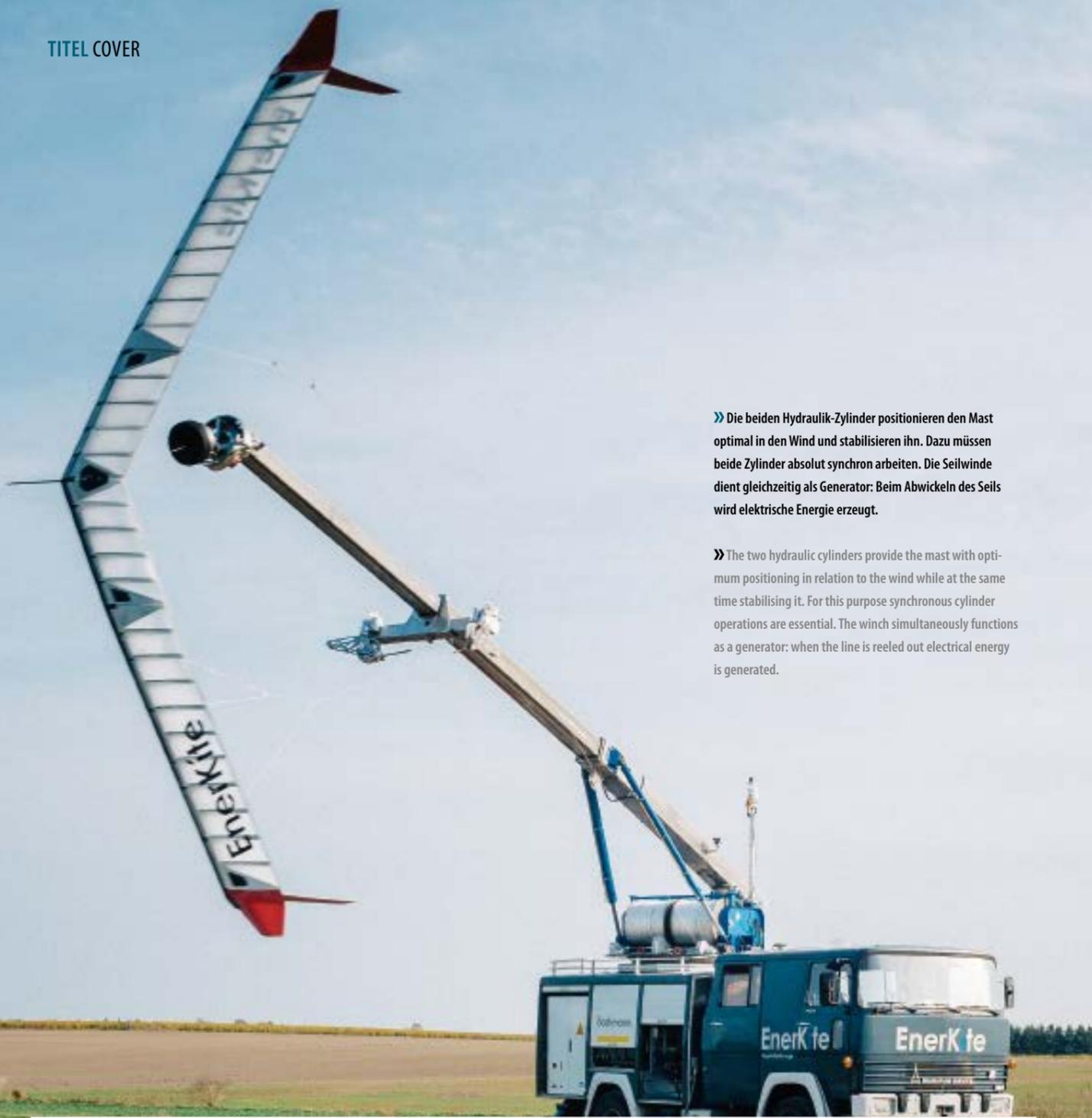
» Die beiden Hydraulik-Zylinder positionieren den Mast optimal in den Wind und stabilisieren ihn. Dazu müssen beide Zylinder absolut synchron arbeiten. Die Seilwinde dient gleichzeitig als Generator: Beim Abwickeln des Seils wird elektrische Energie erzeugt.
