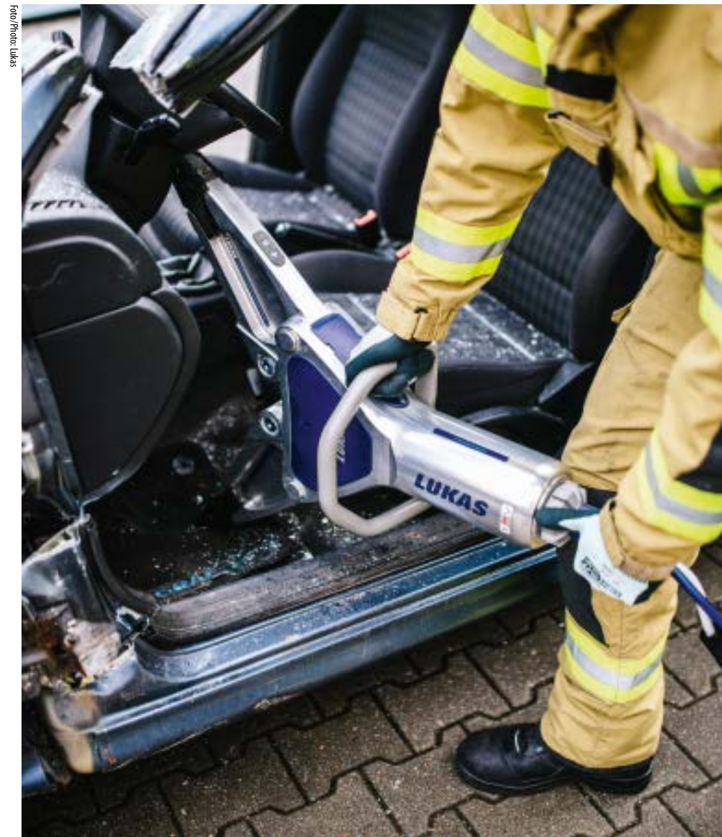
» Der hydraulische Rettungsspreizer kann stark deformierte Fahrzeugteile schrittweise und mit hoher Präzision auseinanderbiegen. » The hydraulic rescue spreader can bend strongly deformed vehicle parts apart gradually and with high precision.
