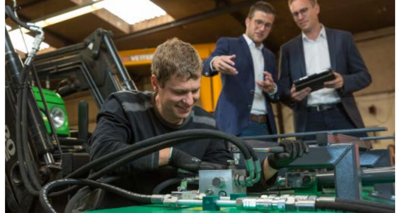
Für SMB wurde ein zentraler Ventilblock von HANSA-FLEX entwickelt. Dadurch kann der restliche Hydraulikkreislauf platzsparender ausgelegt werden.
