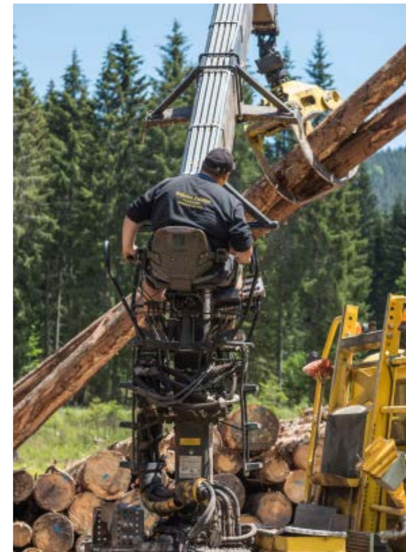
Mächtiger Hydraulikzylinder setzen den 8,60 m langen Arm in Bewegung. An dessen Spitze ist ein ebenfalls hydraulisch bewegter Greifer.
