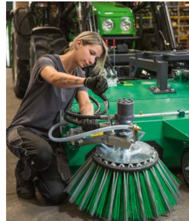
Alle Kehrmaschinen haben eine Gemeinsamkeit: Sie nutzen Hydraulik zur Kraftübertragung.
