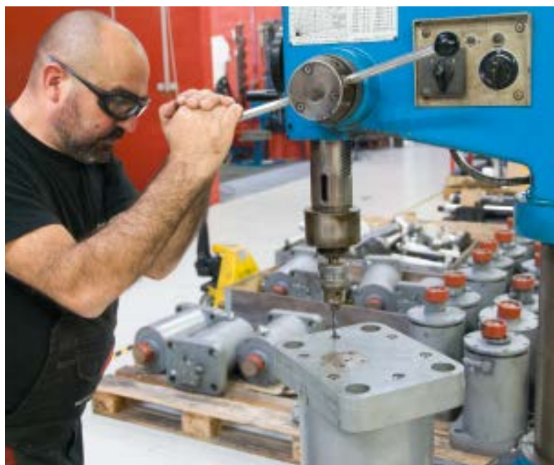
In der HANSA-FLEX Niederlassung Maia demontieren Werkstattmitarbeiter die Dämpfer vollständig, ersetzen Dichtungen, Verschraubungen sowie weitere Montageteile. Die Kolbenstange wird komplett neu gefertigt.
