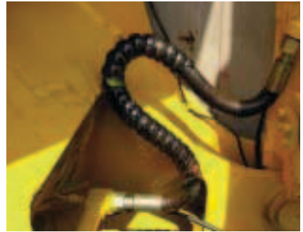
Abb. 4.232 Mindestbiegeradius, mehrfach unterschritten
