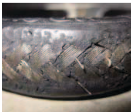
Abb. 4.231 Geschädigte Einlage nach Entfernen der Außenschicht
